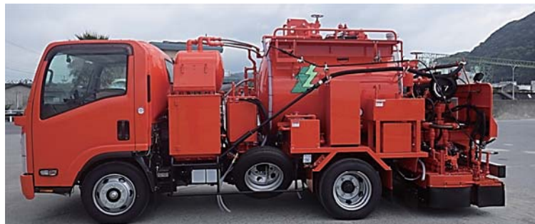
改質アスファルト乳剤・分解促進剤 同時散布対応型ディストリビュータ
