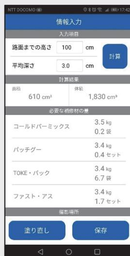
ポットホール面積・体積が自動計算され、補修材の必要量がわかります。
