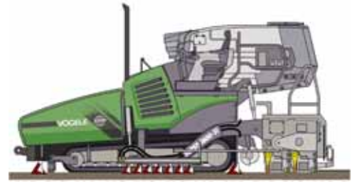
SPAF : 乳剤散布装置付きアスファルトフィニッシャー
