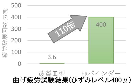
FRバインダーは、曲げ破断ひずみが大きいいため、低温時のひび割れ抵抗性に優れています。
