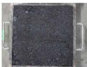
プライムファイン 試験終了時点(60分後)の変形
