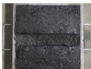
PK-3 試験終了時点(1分後)の変形
