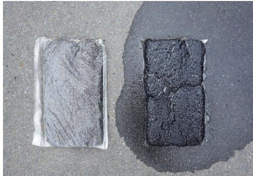
◆TOKE・パックの包装材は水と接触すると直ちに溶解し、アスファルト混合物が露出します。そのため、包装材がアスファルト混合物中に残存したり、ゴミが発生することはありません。
