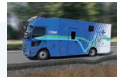
舗装たわみ量と路面性状を同時に測定する車両「MWD plus」
