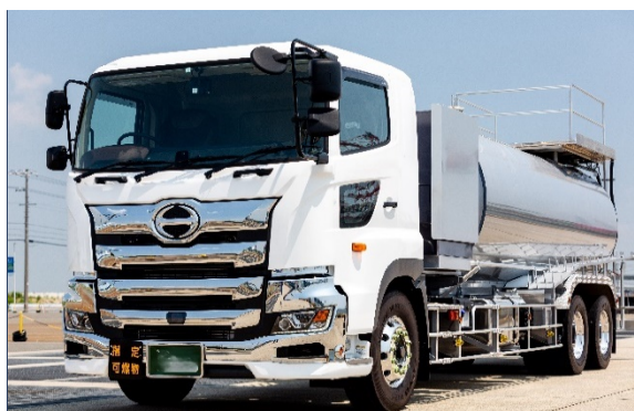
アスファルトを運ぶローリー
