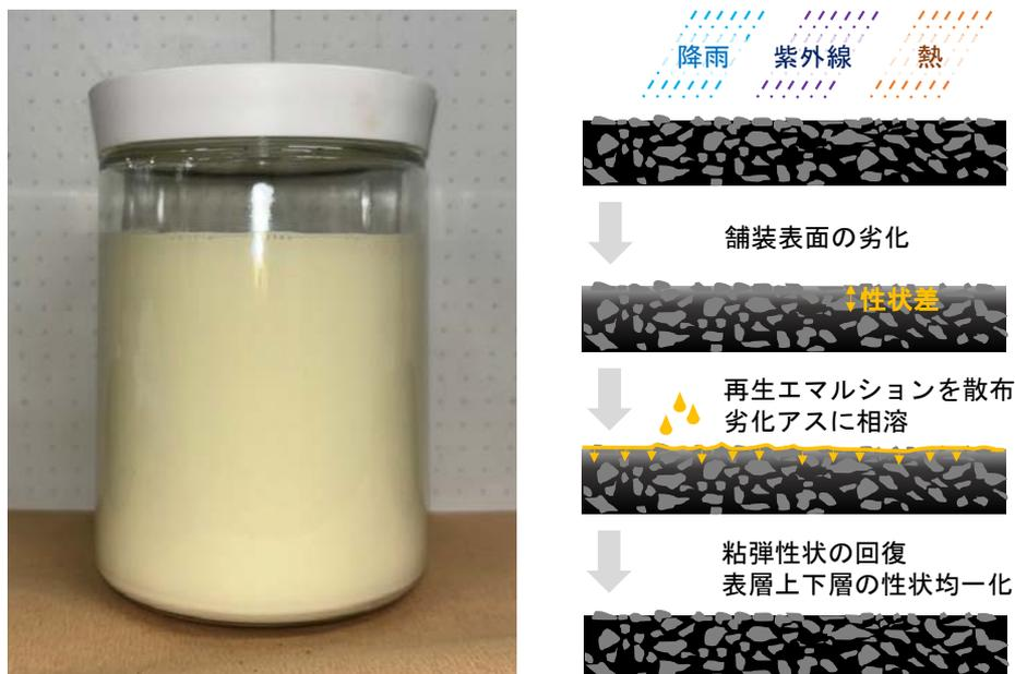
散布型路上表層再生エマルジョンの外観と浸透再生作用の概念図
