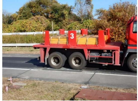
写真-2 舗装走行実験場での荷重車走行状況
